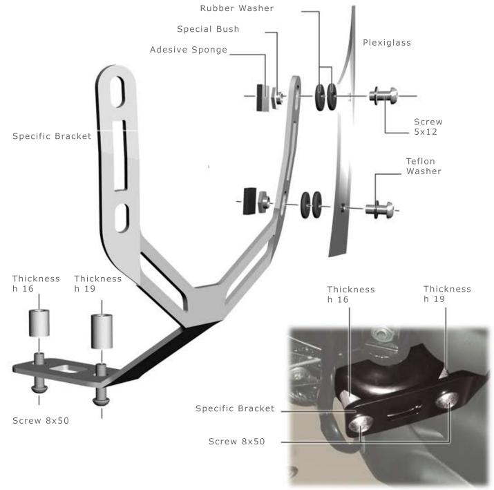
PUT AND MOUNT THE WINDSHIELD/SCREEN ON THE SPECIFIC BRACKET LIKE SHOWN IN THE PICTURE. REMOVE THE ORIGINAL BRACKET THAT SUPPORT THE DOUBLE LIGHT. POSITION BARRACUDA SPECIFIC BRACKET ON THE WINDSHIELD/SCREEN MOUNTED BEFORE, PASSING THAT BETWEEN THE TWO LIGHTS AND PUT IT UNDER THE ORIGINAL BRACKET ATTACK (SEE THE PICTURE). USE THE SPECIFIC THICKNESS AND THE 8X50 SCREWS INCLUDED IN THE KIT (SEE THE PICTURE).
